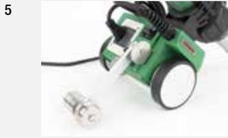
**5** **Sensor de arranque integrado:** Con el retardo de arranque ajustable individualmente del dispositivo de guía (Drive Unit) MINIFLOOR, el arranque puede adaptarse en cualquier momento a las necesidades específicas de cada situación. El brazo guía garantiza una precisión extraordinaria.
